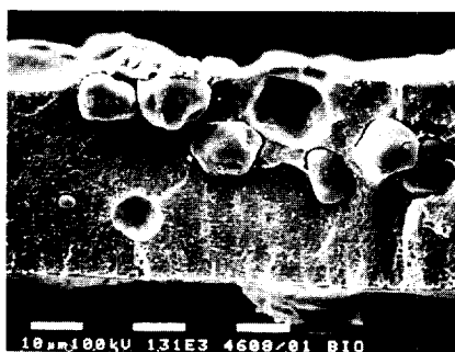
그림 1. 기존 전분충전형 film의 전자현미경 단면사진.
